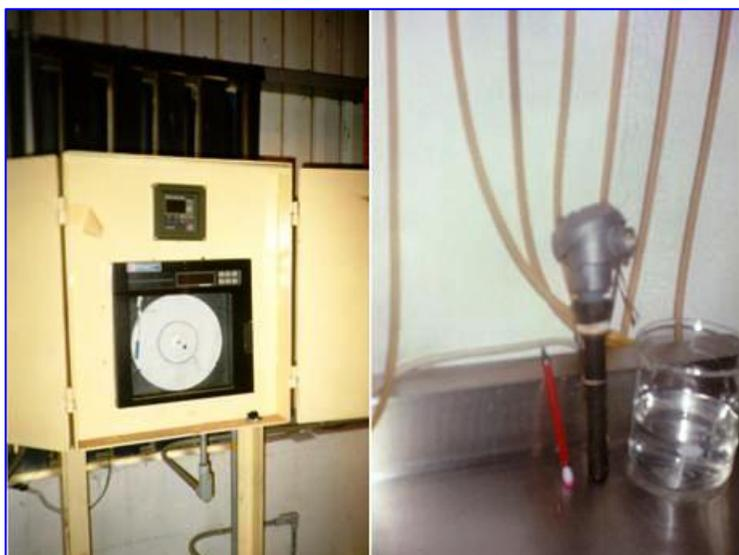
*Fig. 1. Equipo de medición de conductividad eléctrica
