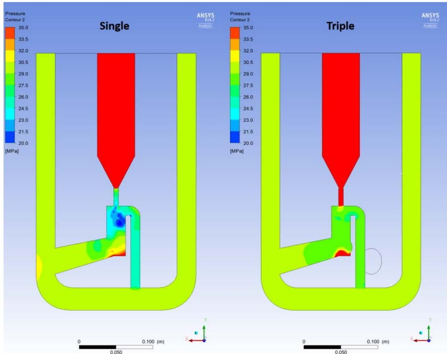
(b) Venturi Nozzle Diameter: 1/4" (6.35 mm)
