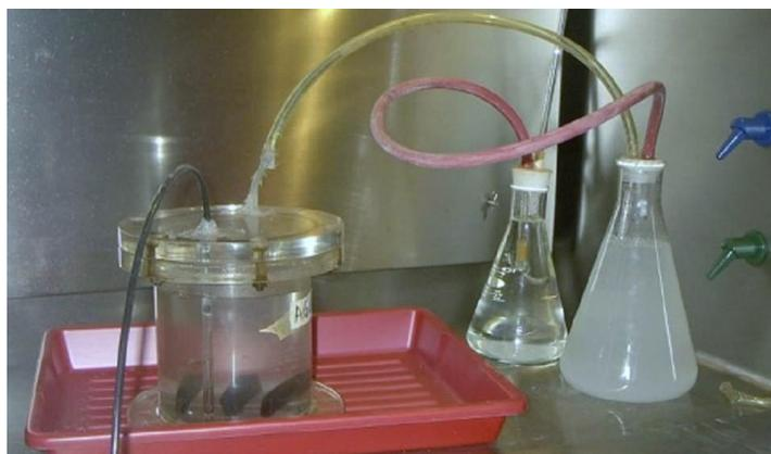
Fig. 2. Arreglo para la prueba HIC
