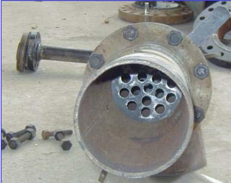
Fig. 7. Prototipo del silenciador propuesto.
